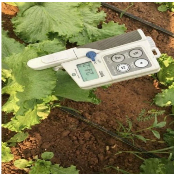
Medição de Teor de clorofila com SPAD
