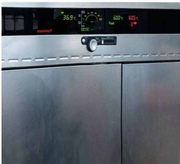
Estufa usada, temperatura ajustada 65 °C
