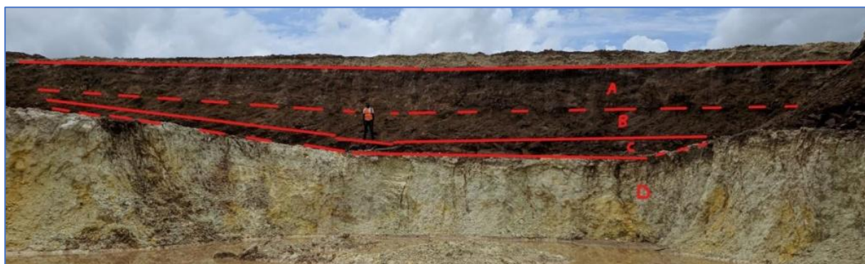
Figura 5. Afloramento presente na mina da MIMOC ilustrando diferentes horizontes no solo. Fonte, Mulungo 2022.
