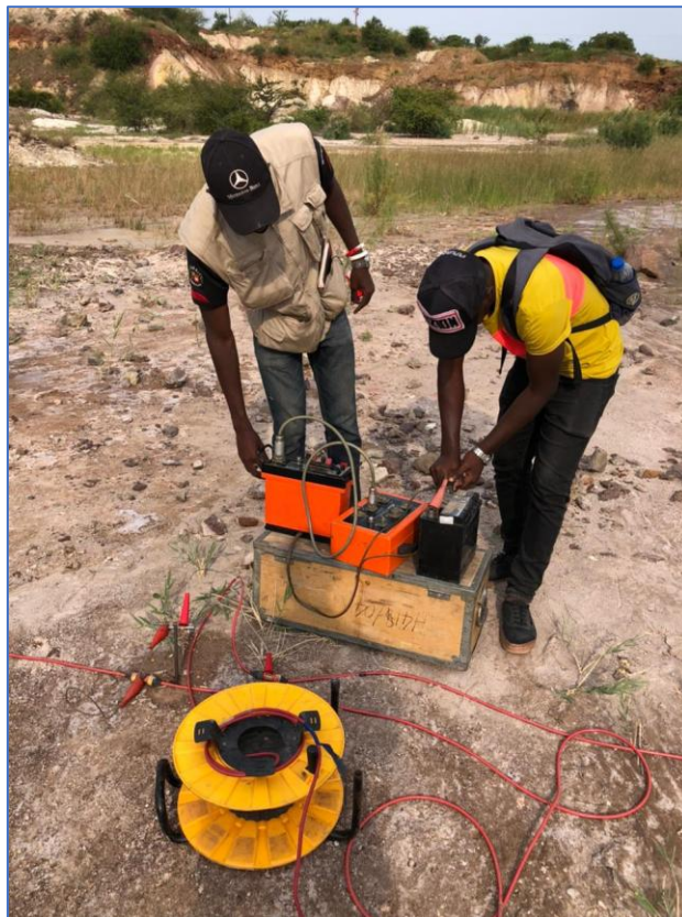
Anexo 10. Fotografia retirada na estação um, na realização da Tomografia De Resistividade Eléctrica. Perfil G21.
