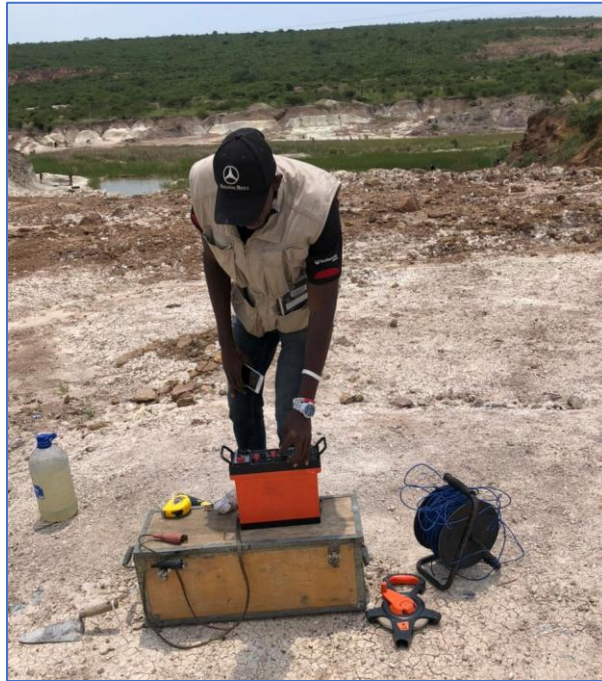
Anexo 10. Fotografia retirada na estação um, na realização da Tomografia De Resistividade Eléctrica. Perfil G21.
