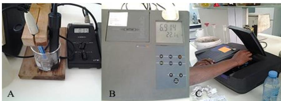
Figura 14: Equipamentos laboratoriais, A- Condutímetro; B- pH metro; C- Espectrofotómetro de absorção molecular.
