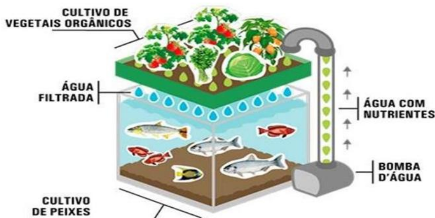
Figura 1. Sistema básico de aquaponia
