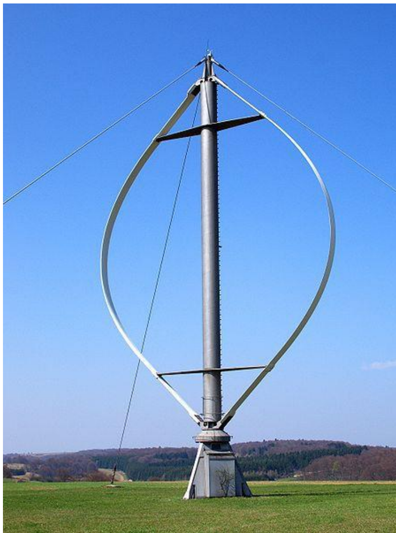
Figura 2. 13: Aerogeradores de eixo vertical tipo Darrieus (Braga, et al., 2012).
