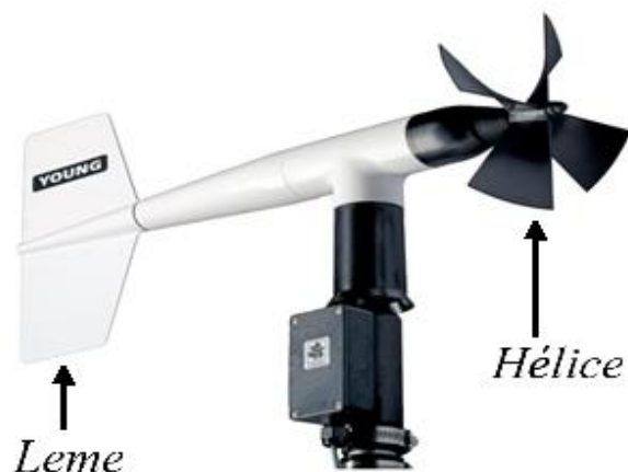
Figura 2. 7: Ilustração do Anemômetro de hélice com o sensor de velocidade a direita (hélice) e de direcção á esquerda (leme) ( https://goo.gl/images/myyoxxy )
