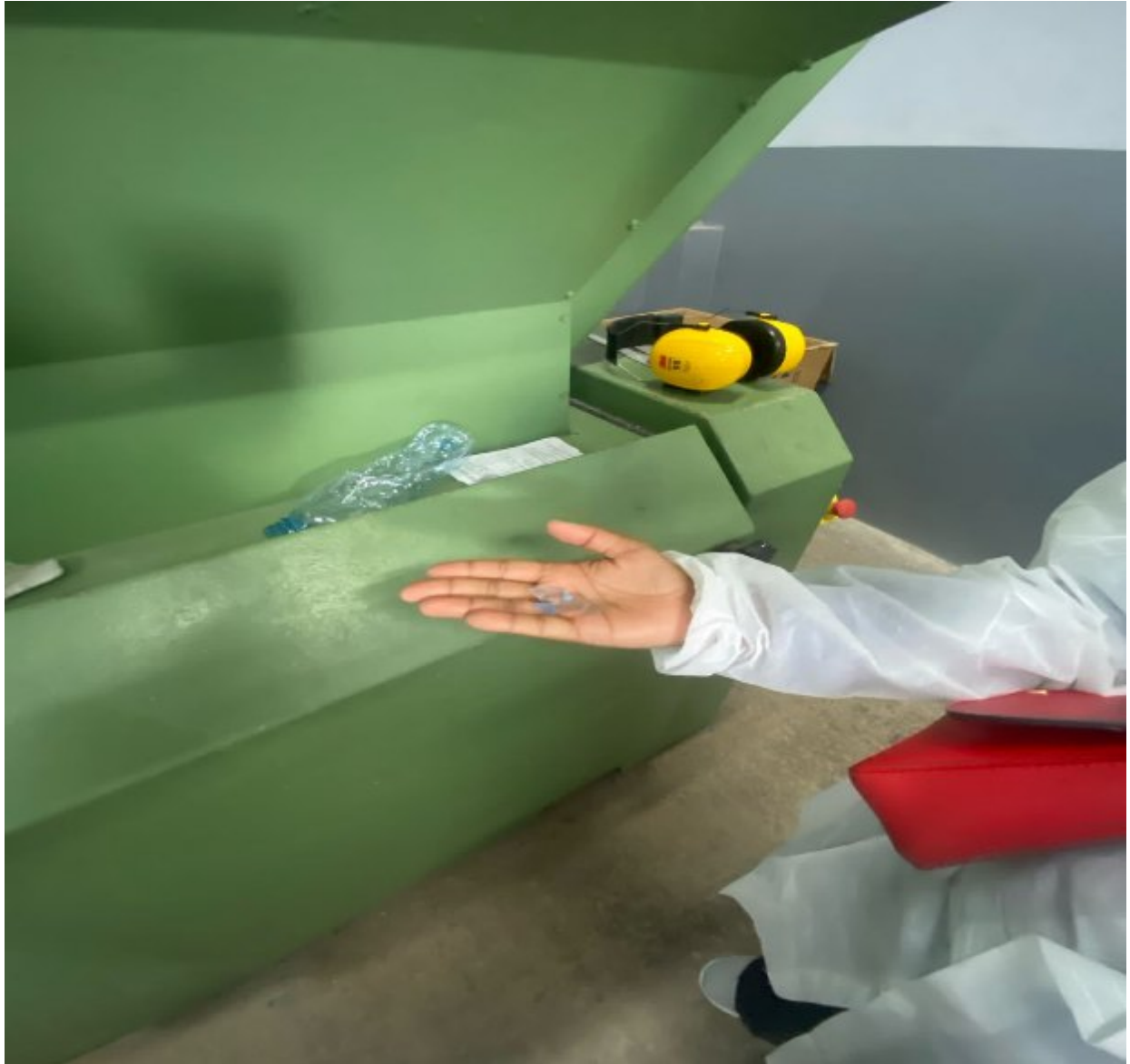
Imagem 8: Máquina trituradora de garrafa pet
