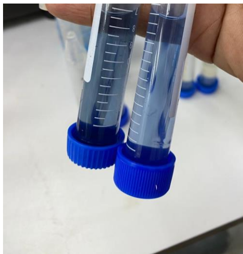
Figura 7. Tubos de ensaio contendo amostras após reação com o reagente PhosVer 3.
