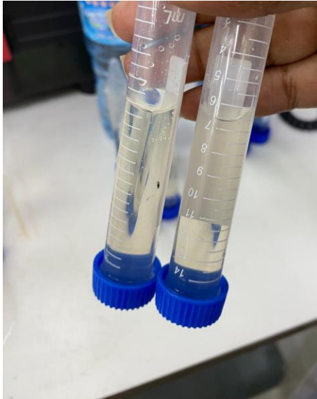
Figura 8. Tubos de ensaio contendo amostras após reação com o reagente NitraVer 5.
