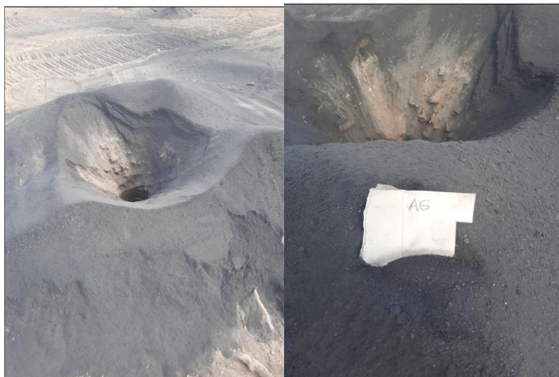
Figura 6: Furo de desmonte com presença de carvão na pilha “camada Grande Falésia” (Fonte: Autor, 2024)
