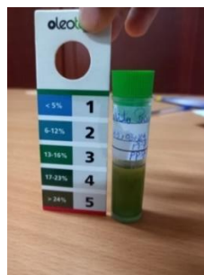
Figura IV: (a)- Embalagem de oleotest®; (b)- Tubo de teste e respectiva escala colorimétrica
