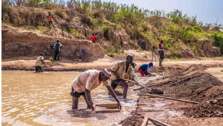
Figura 3: Bacia de lavagem de minério utilizadas na mineração artesanal de ouro em Tete, Moçambique, onde o mercúrio é adicionado para amalgamar o ouro e separado do material rochoso através da lavagem com água. Fonte (autora).
