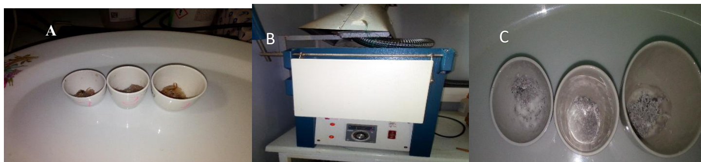
Figura B2: A- amostras antes da carbonização, B- na Mufla, C- amostras carbonizadas.
