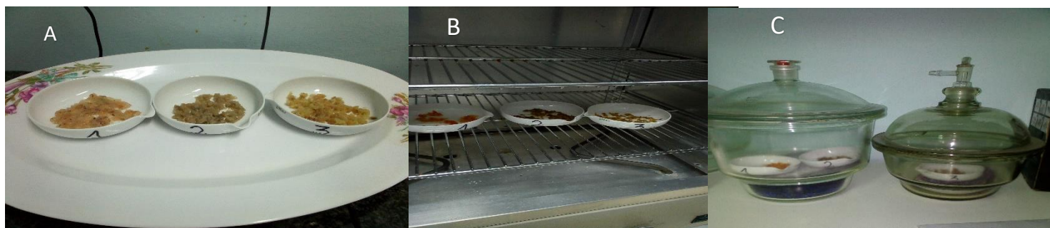
Figura B1: A- amostras antes da desidratação, B- na estufa, C- no exsiccador para posterior pesagem.
