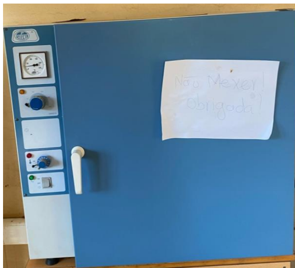
Figura 2: Estufa de ar forçado utilizada para o processo de secagem das amostras em temperatura de 105°C, para posterior determinação do teor de humidade.
