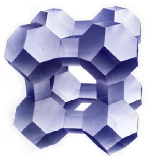
Figura 10: Peneira molecular do tipo A (Mokthab, et al., 2019)
