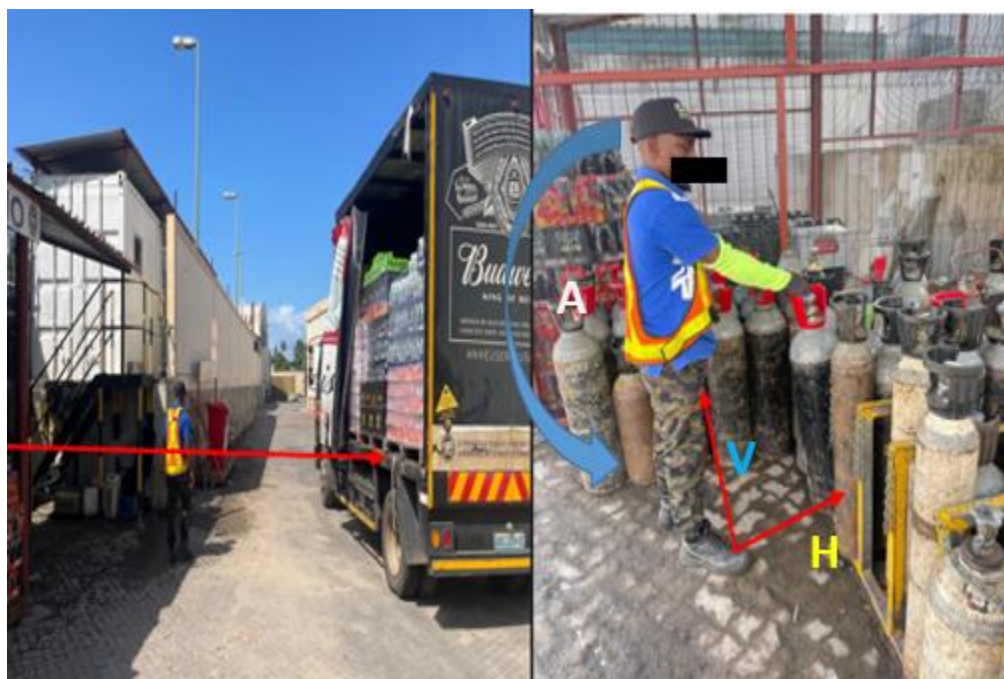
Figura 28- Remoção de cilindro de CO 2 na gaiola de armazenamento
