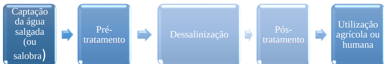
Figura 2 – Linha convencional de tratamento de água por dessalinização. Fonte [10]
