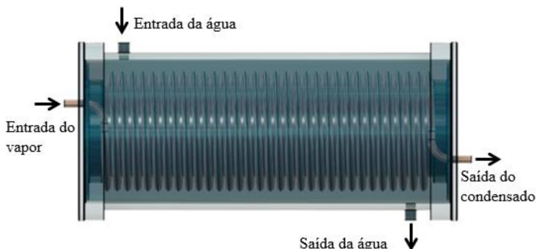
Figura 10 – Condensador tipo Casco com serpentina submersa.
