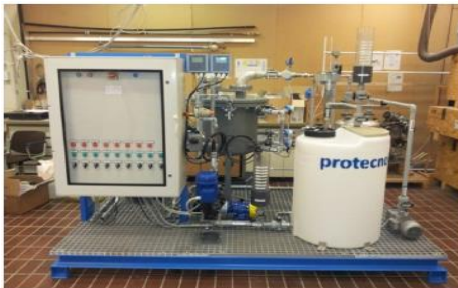
Figura 8 – Protótipo de dessalinização térmica. Fonte [22]
