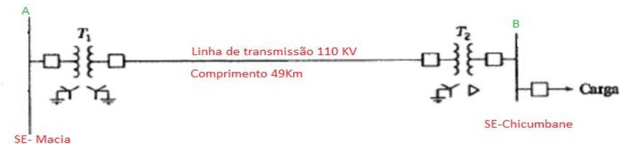
Figura 6: Diagrama unifilar da linha de transmissão CL2. [Fonte: Autor]
