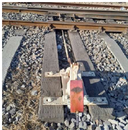
Figura 11: Aparelhos de mudança de via (Fonte: Autor, 2025)
