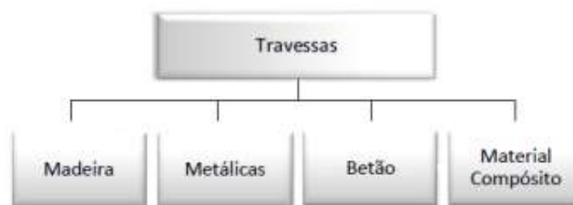
Figura 10: Tipo de materiais utilizados em travessas (Fonte: Ferreira, 2007)
