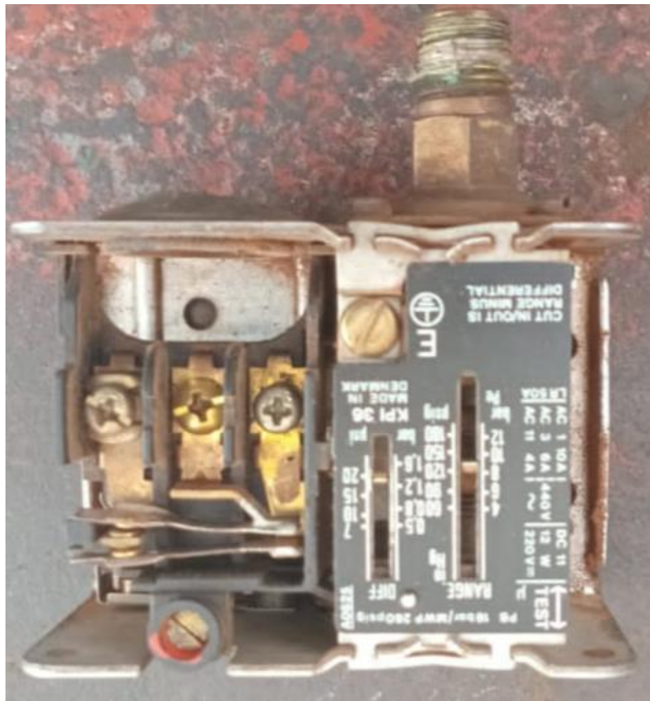
Figura A 9.1- 18. Pressóstato danificado. Fonte: Autor
