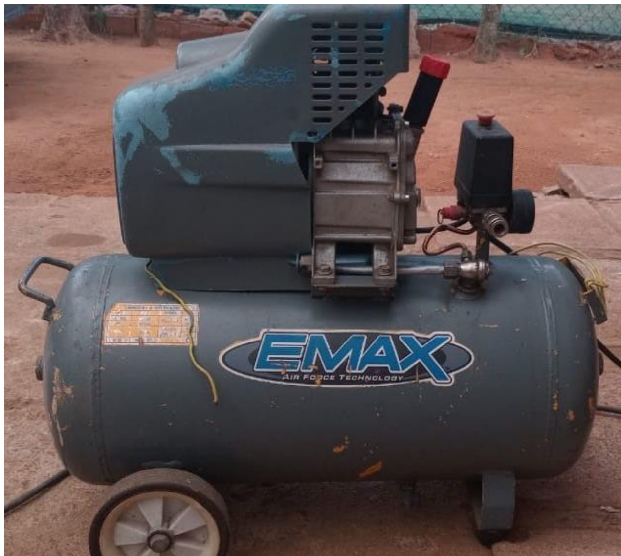
Figura A 4.1- 13. Compressor de marca EMAX. Fonte: Autor
