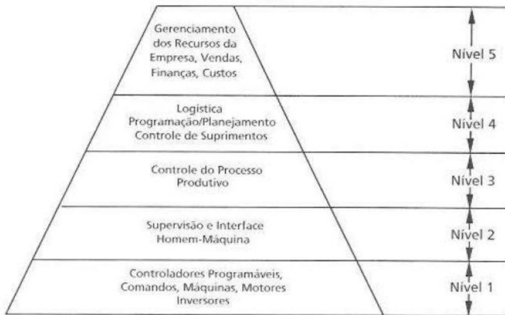
Figura 16: Divisão hierárquica de um processo de automação industrial [1].
