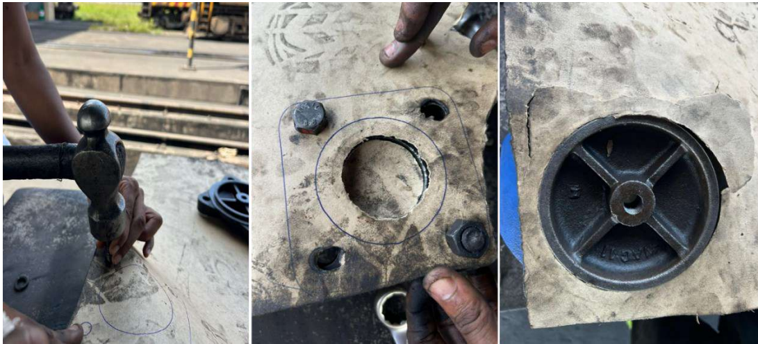
Figura 14: Fabricação Manual de juntas na CFM-Sul.
