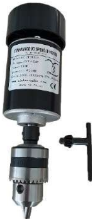
Figura 8: Motor principal com bucha porta ferramenta.
