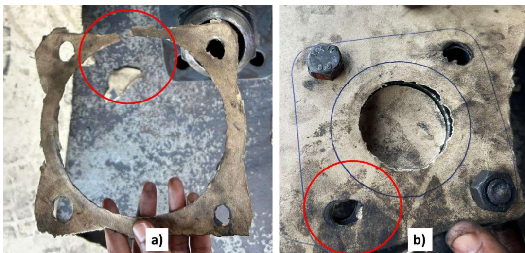
Figura 16: a) Defeito por corte da junta e b) Defeito de posicionamento dos furos.
