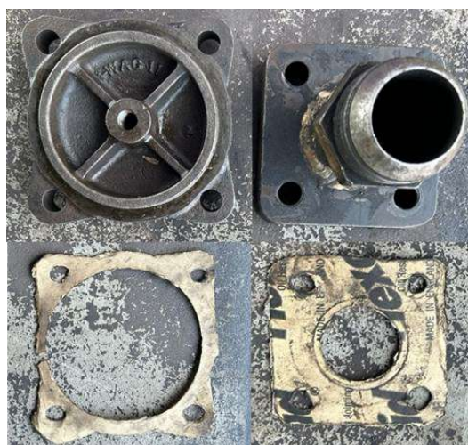
Figura 15: Juntas feitas manualmente na CFM-Sul.
