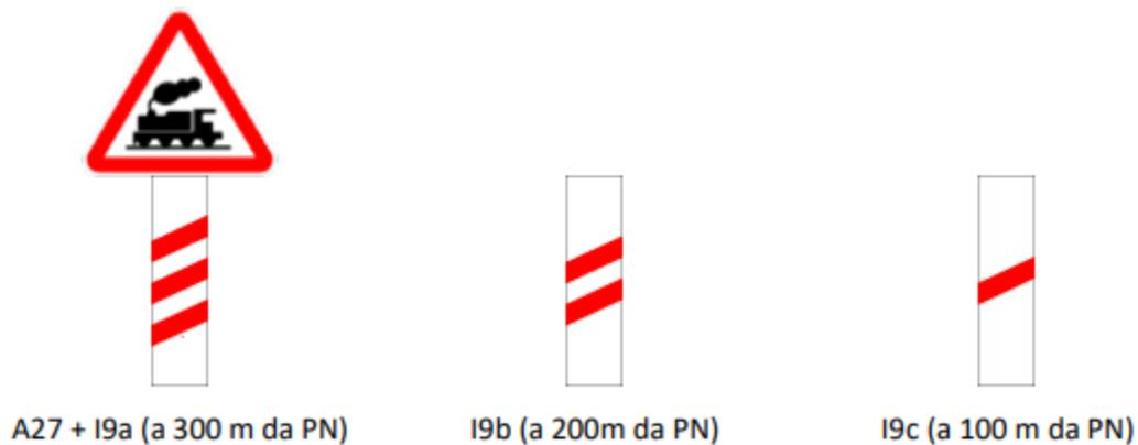
Figura 8: Sinais de pré-sinalização de aproximação de PN sem guarda (Fonte: Instituto de Mobilidade e dos Transportes, I.P)
