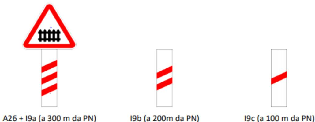
Figura 7: Sinais de pré-sinalização de aproximação de PN com guarda (Fonte: Instituto de Mobilidade e dos Transportes, I.P)
