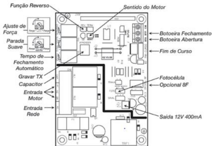
Figura 23: partes principais duma cancela automática (Fonte: Optsis)
