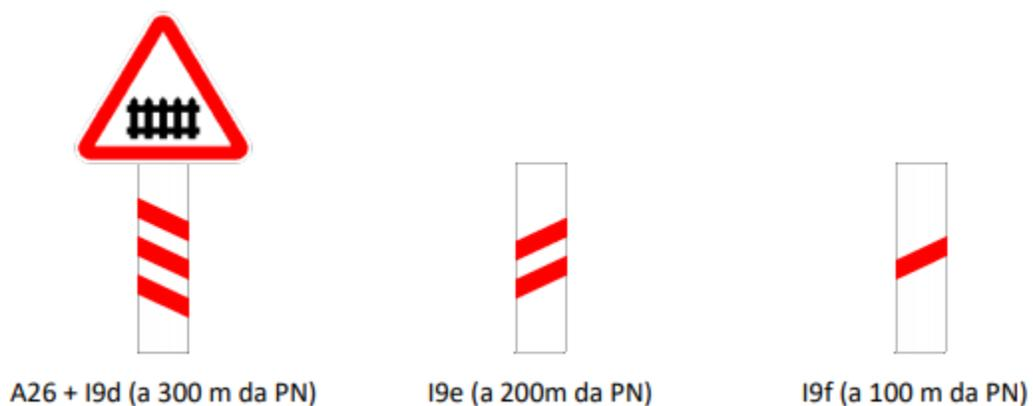
Figura 9: Sinais de pré-sinalização de aproximação de PN com guarda (Fonte: Instituto de Mobilidade e dos Transportes, I.P)
