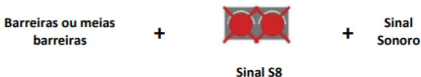
Figura 14: Passagem de nível do tipo B (Fonte: Instituto de Mobilidade e dos Transporte, I.P)
