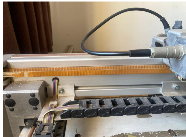
(b) Correia completamente danificada.
