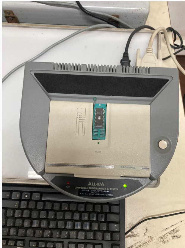
Figura 4.4: Programador e testador Universal ALL-07A. Fonte: O autor (2025)
