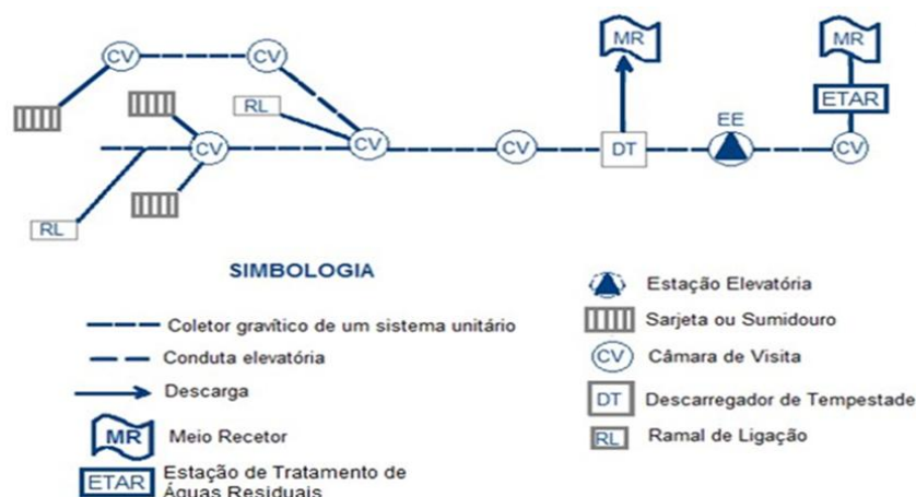
Figura 1- Representação esquemática de um sistema do tipo unitário.
