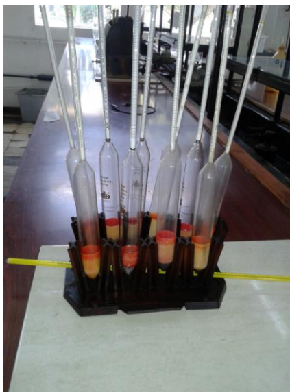
Figura 9: Ilustração de densímetros para a determinação da massa específica a 20 °C.
