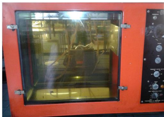
Figura 11: Ilustração de um banho de viscosidade para determinação da viscosidade cinemática do gasóleo.
