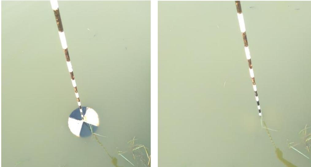
**Figura IV:** Uso de Disco de Secchi para mensurar a transparência da água.
