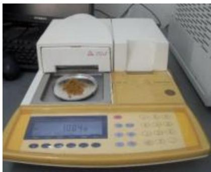
*Figura 1. Analisador de humidade*
