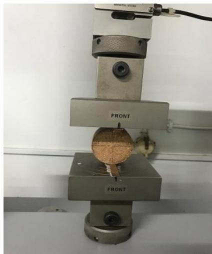
*Figura 5. Teste de resistência à tração por compressão diametral de corpos de prova cilíndricos*
