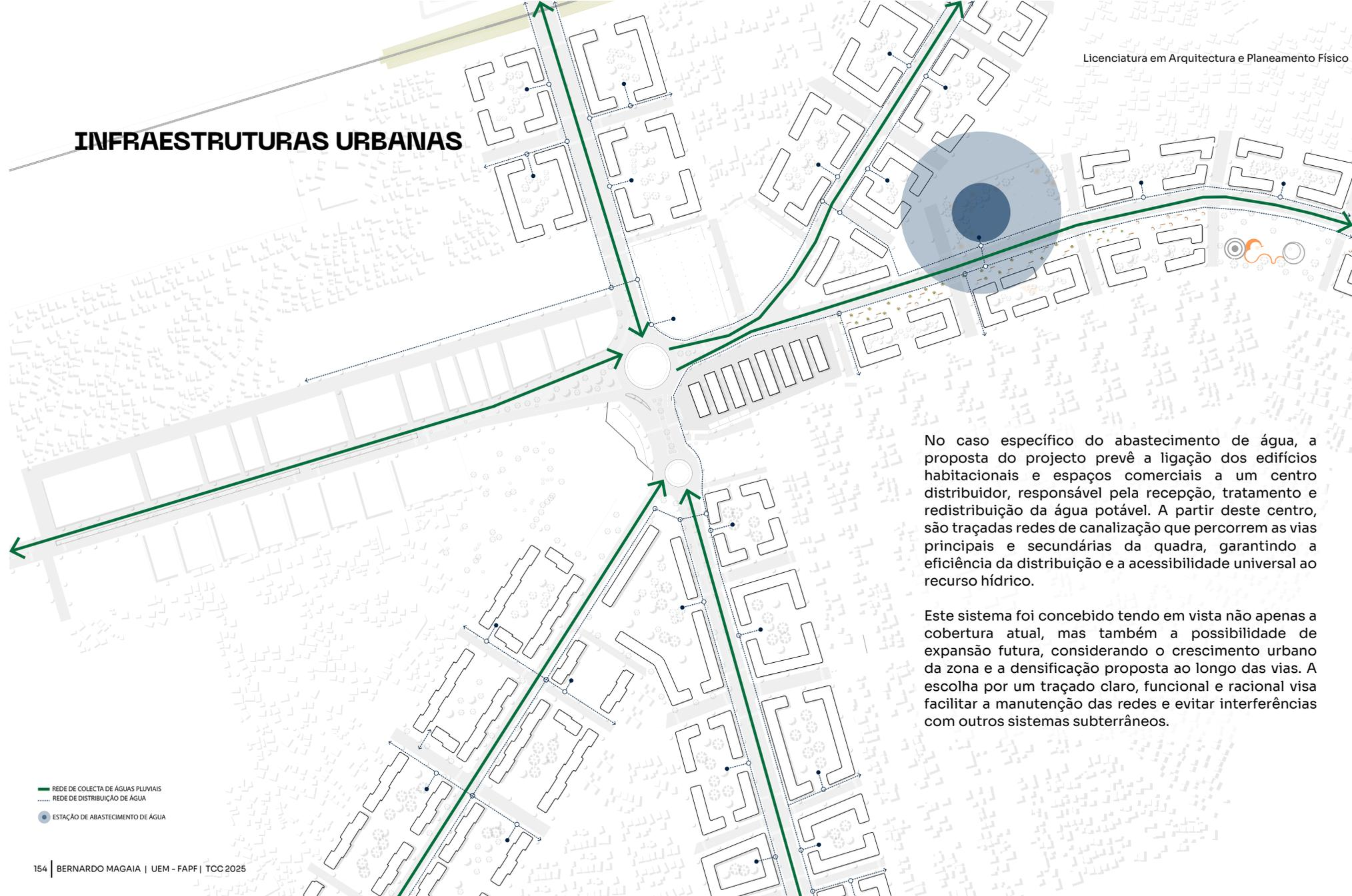
No caso específico do abastecimento de água, a proposta do projecto prevê a ligação dos edifícios habitacionais e espaços comerciais a um centro distribuidor, responsável pela recepção, tratamento e redistribuição da água potável. A partir deste centro, são traçadas redes de canalização que percorrem as vias principais e secundárias da quadra, garantindo a eficiência da distribuição e a acessibilidade universal ao recurso hídrico.
