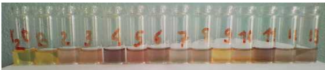
Figura 9: Efeito do pH no teste colorimétrico das AgNPs para atrazina.
