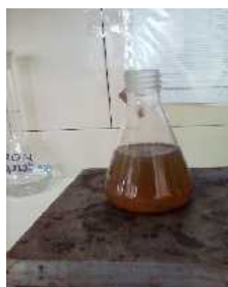
Figura 8: Cor das nanopartículas de prata quando se exagera a quantidade de citrato de sódio adicionada à solução de AgNO_3 .
