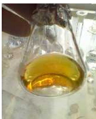
Figura 7: Nanopartículas de prata na sua cor adequada (amarelo dourado), quando não há excesso ou défice nas condições de preparação.
