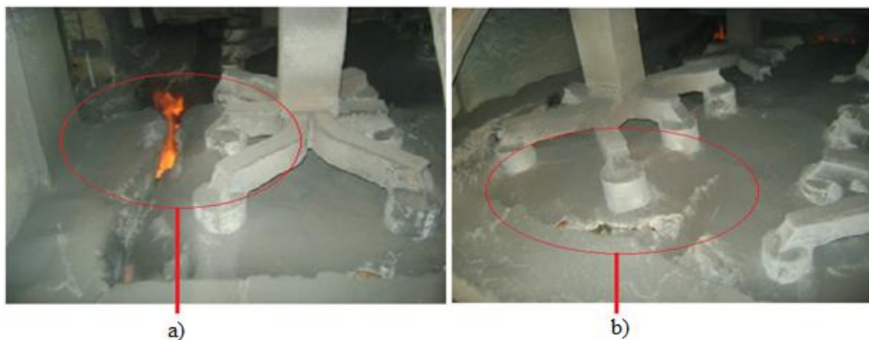
Figura 30. Integridade da cobertura dos ânodos no pote de referência (C079). a) Imagem frontal dos ânodos dentro do pote. b) Imagem lateral dos ânodos dentro pote.
