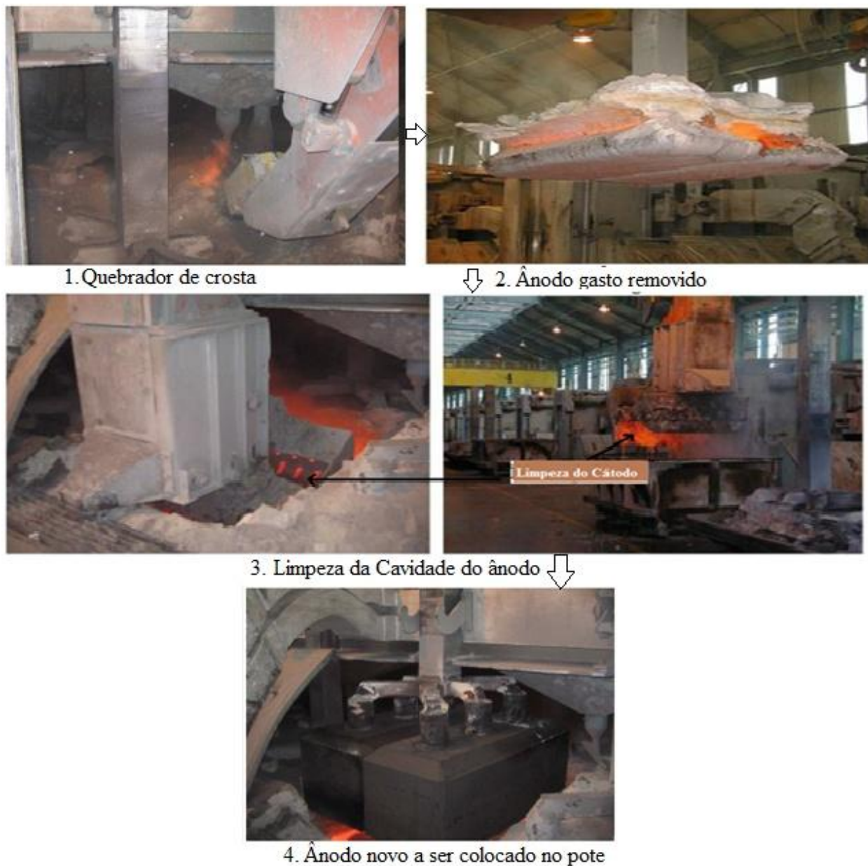
Figura 27. Processo de troca de ânodos e limpeza da cavidade (Fonte Mozal).
