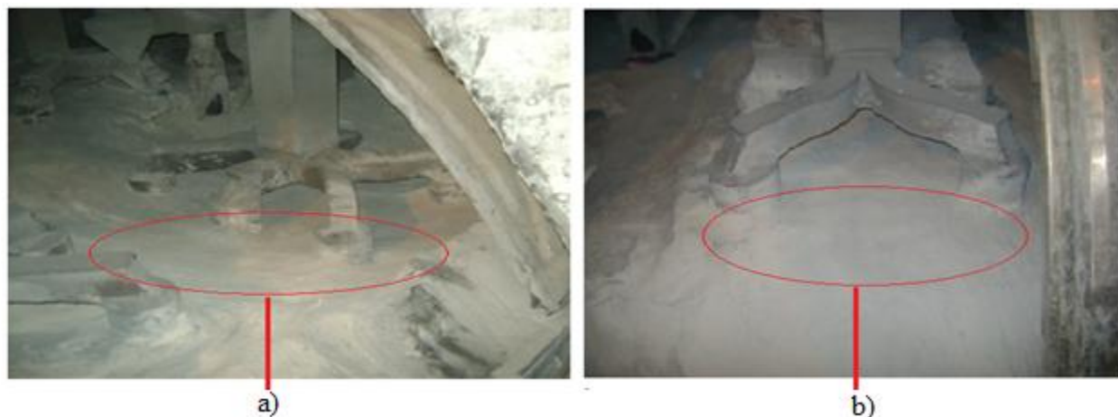
Figura 31. Integridade da cobertura dos ânodos nos potes de teste. a) Imagem do pote C080. b) Imagem do pote C081.
