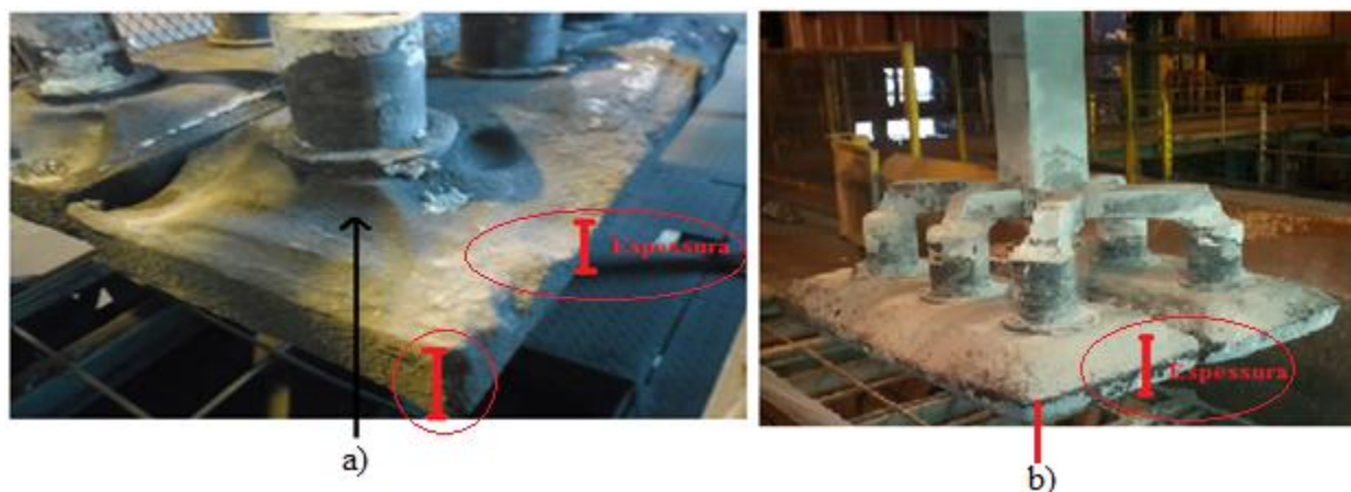
Figura 42. Imagem do impacto da oxidação de carbono na espessura dos ânodos. a) Ânodo com espessura reduzida. b) Ânodo com espessura maior espessura de proteção dos pinos.
