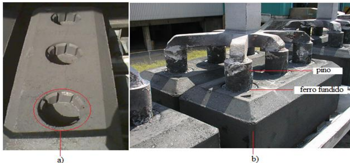
Figura 9. Imagem de ânodo. a) Bloco de carbono antes do chumbamento, b) bloco de carbono depois do chumbamento (Fonte Mozal).
