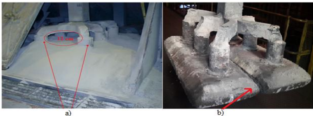
Figura 35. Ânodos com cobertura adequada (a) e ânodo gasto sem oxidação (b).
