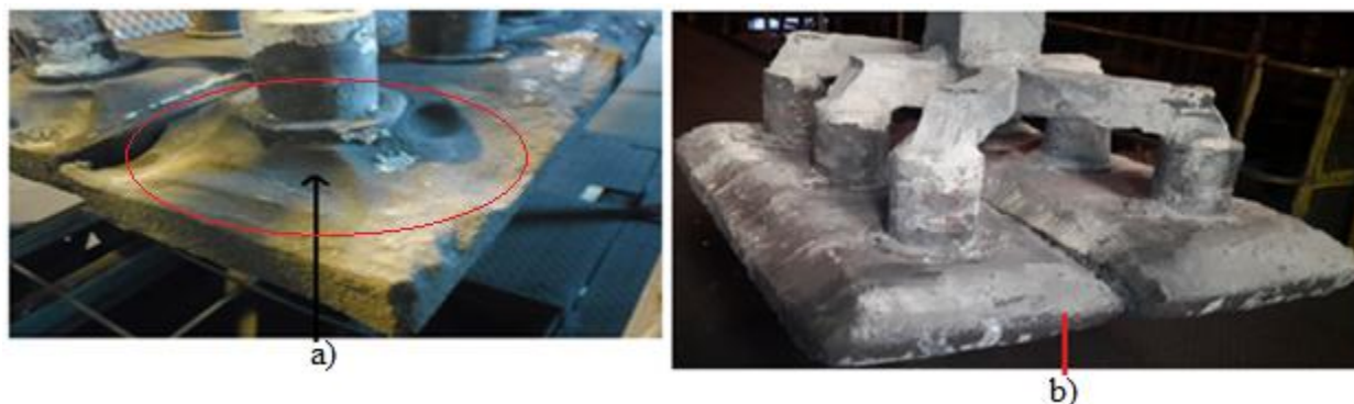
Figura 40. Impacto da oxidação no peso do ânodo gasto: a) ânodo oxidado (pote de referência). b) Ânodo não oxidado (potes de teste).
