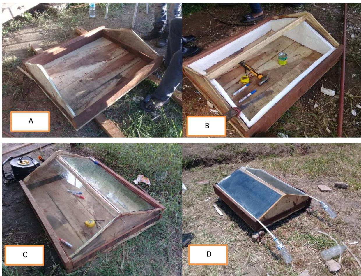
**Figura 11:** Etapa da construção do dessalinizador solar. a) Concepção da base; b) colocação de Esferovite; c) colocação de vidro; d) exposição do experimento a luz solar.
