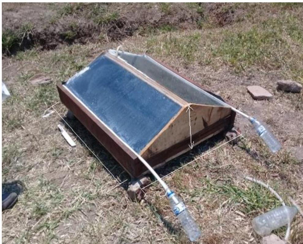
*Figura 12: Dessalinizador construído. Fonte Autor*
