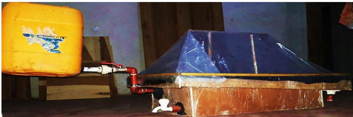
**Figura 8:** Dessalinizador Electro-Solar. (Paixão, 2017).
