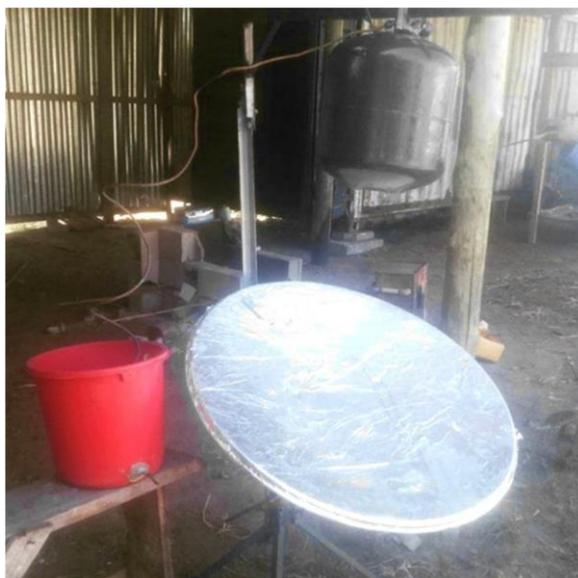
**Figura 9:** Dessalinizador acoplado a concentrador solar (Sengo, 2019).
