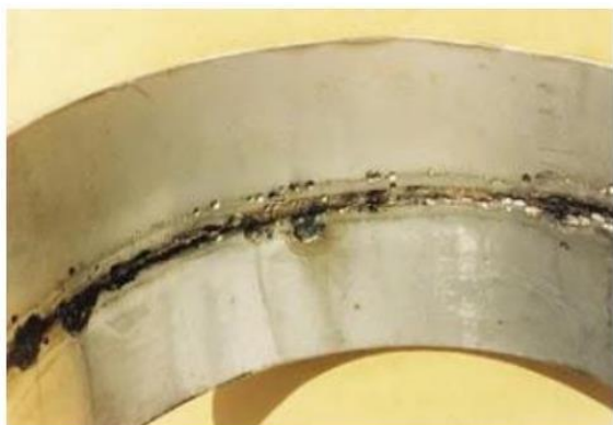
Figura 9. Corrosão em torno do cordão de solda
