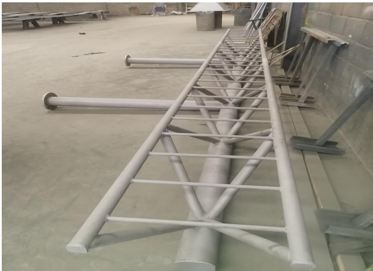
Figura 14. Escada depois da decapagem
