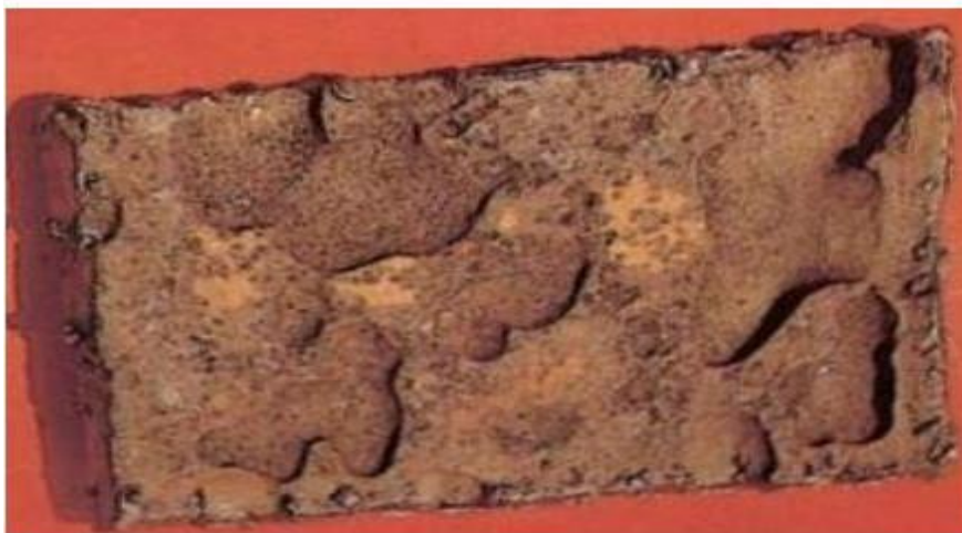
Figura 8. corrosão por placas
