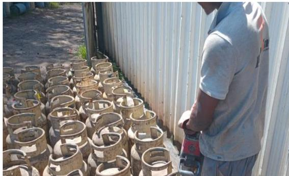
Figura 6: Desmontar válvula com ajuda de torqueímetro
