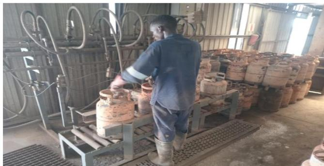
Figura 8: Teste hidrostático
