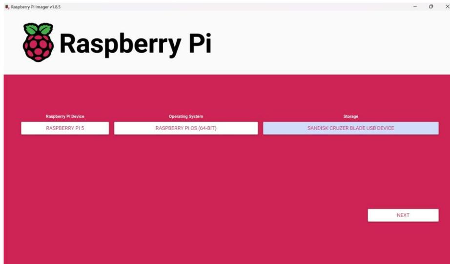
Figura 1.4: Tela com o dispositivo, sistema operacional e armazenamento já selecionados, pronto para instalar. Fonte: [Autor]
