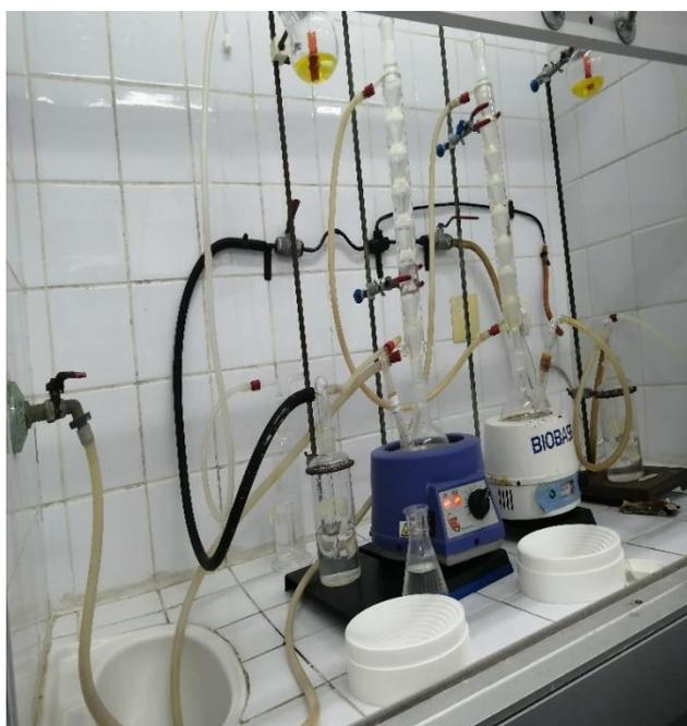
**Figura 7:** Instrumento usado para determinar o Metabissulfito a partir do método do Monier-William.
