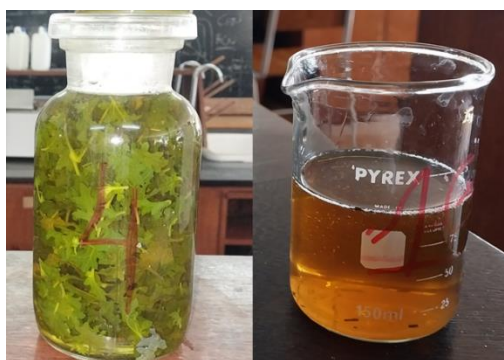
Figura 11 Extracção da mucilagem pelo método de Maceração
