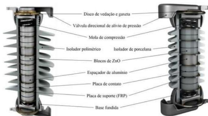
**Figura 6:** Para-raios de ZnO (Fonte: Hubbell Power Systems, 2015)
