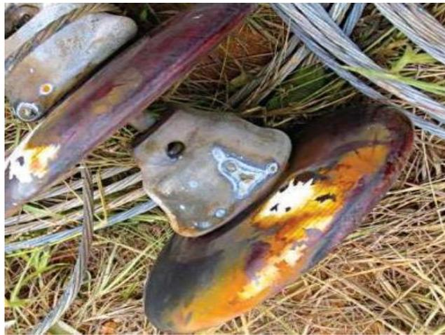
**Figura 5:** Isolador com isolamento rompido (Fonte: INMR, 2017)
