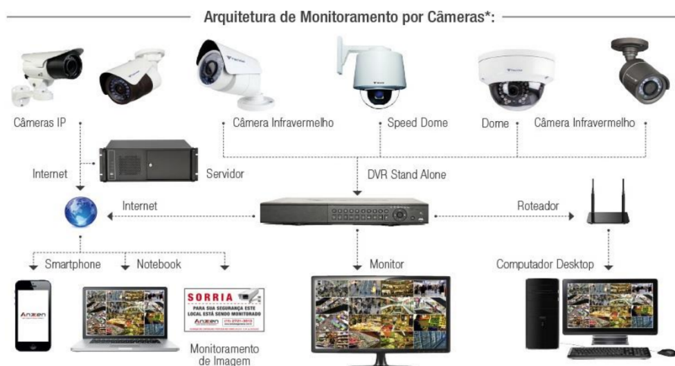
Figura 2.8: Exemplo de uma arquitetura de monitoramento por câmaras completo. Fonte: [CÂMERAS DE SEGURANÇA]
