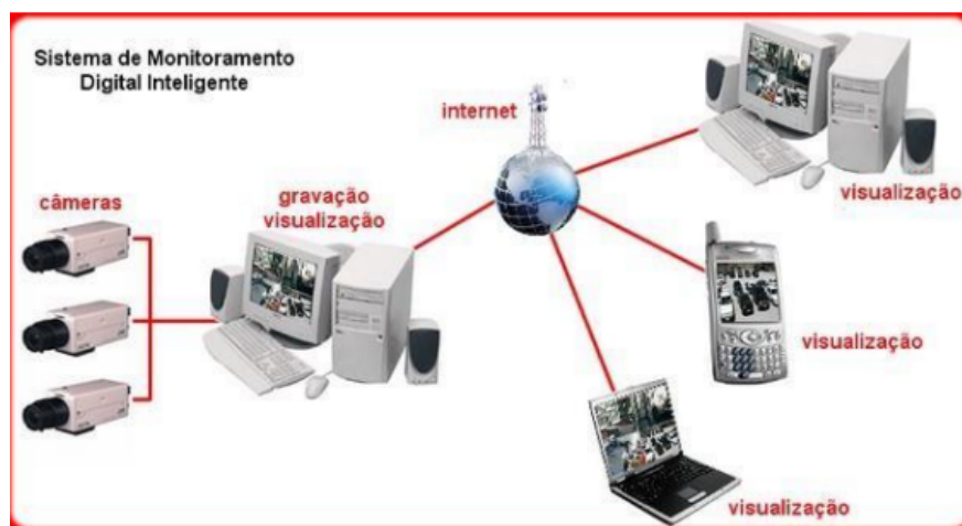
Figura 2.6: Estrutura básica de um sistema de monitoramento. Fonte: [CÂMERAS DE SEGURANÇA]
