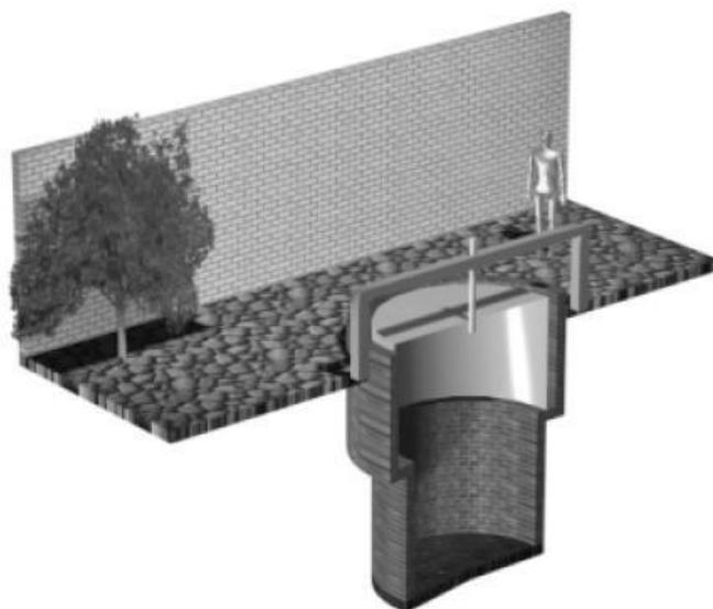
**Figura 7:** Representação tridimensional em corte do biodigestor tipo Batelada.
