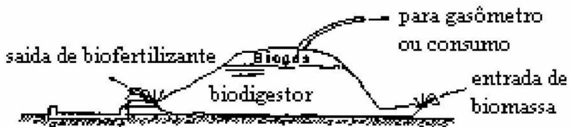
**Figura 8:** Biodigestor tipo Batelada. (CARTERPILAR, 2011)
