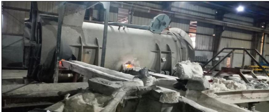
**Figura 8:** Representação do *Tilting Furnace* (TF<sub>1</sub>).
