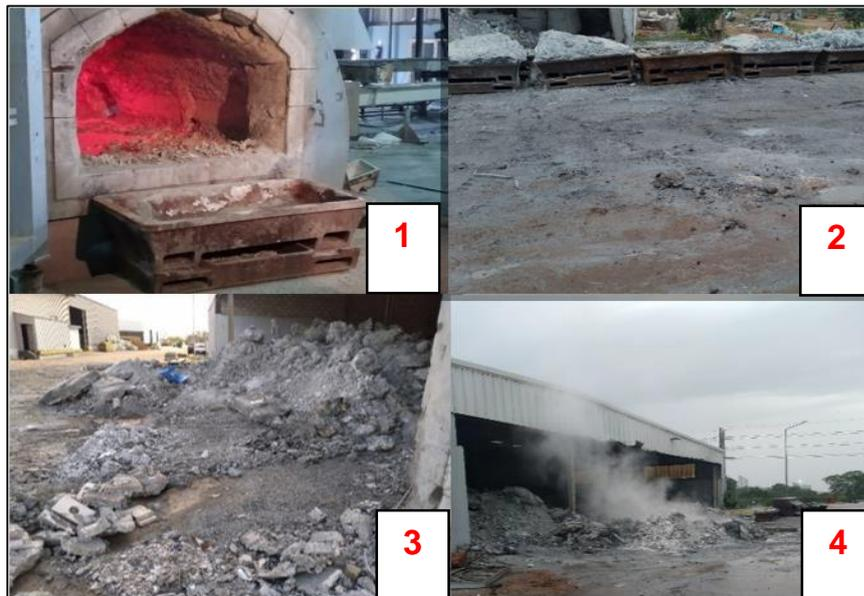
**Figura 19:** Retirada da escória do forno e armazenagem.
