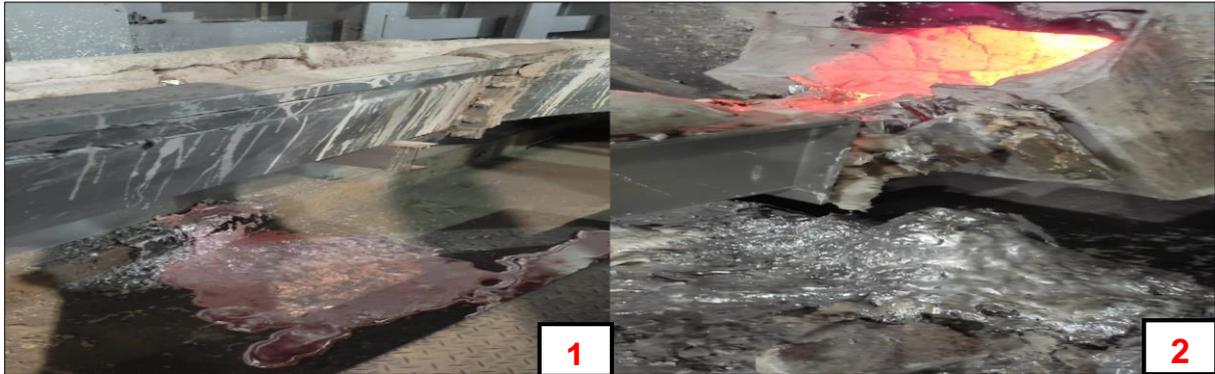
**Figura 16:** Derrame de metal no interior da fábrica, 1,2- derrame de metal no processo de transferência.
