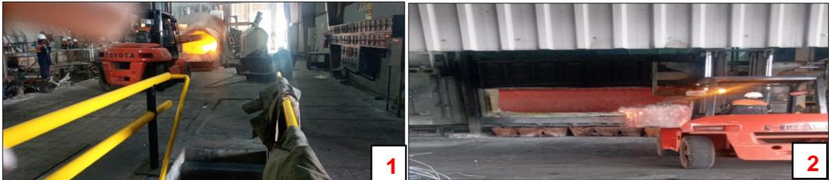
**Fonte :** 1 - Remoção da escória no forno TF<sub>1</sub> e 2 - Remoção da escória no forno TF<sub>2</sub> , Autora (2024).
