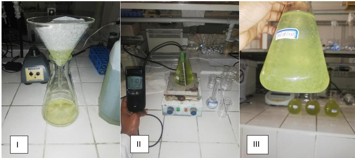
Figura 2A- I- filtração; II- ajuste do pH e agitação; III- solução pós cristalização.
