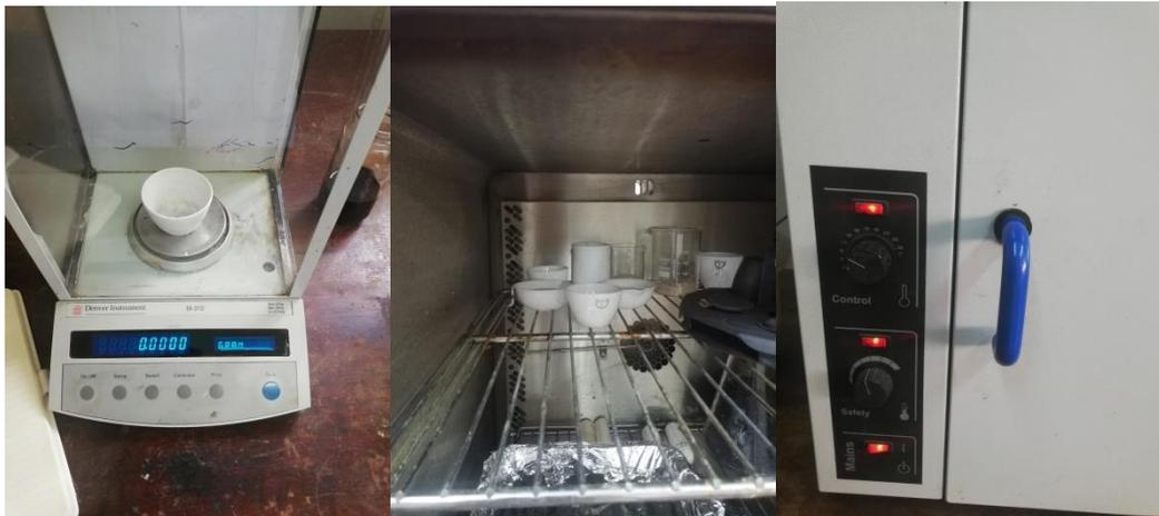
Figura 1A- Processos para determinação de sólidos totais.
