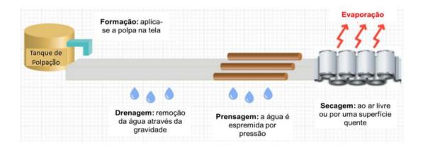
**Figura 2:** Processo resumido de fabricação do papel. Fonte: (VALDIMARSDÓTTIR, 2021) (GLEB, 2019). Adaptado
