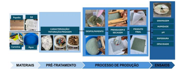
**Figura 9:** Metodologia empregue para desenvolver os papéis reciclados. Fonte: Autor.
