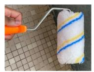
Figura 6: Pincel tipo rolo usado como nivelador e para absorver água. Fonte: Autor
