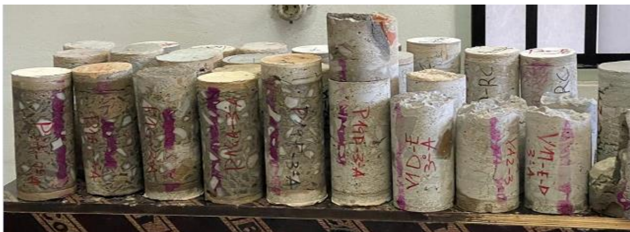
Figura 2: Teste de Carbonatação em carotes
