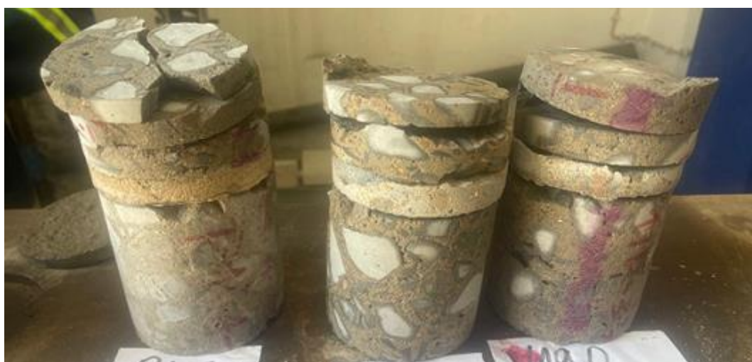
Figura 3: Amostras para a determinação do teor de cloretos e Sulfatos
