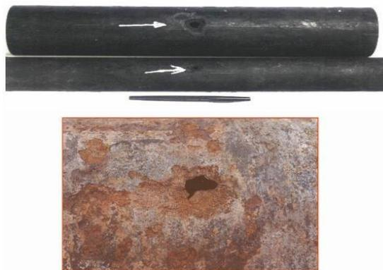
Figura 13: Exemplo de corrosão por correntes vagabundas
