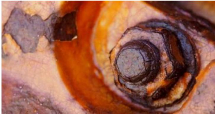
*Figura 6: Corrosão galvânica.*
