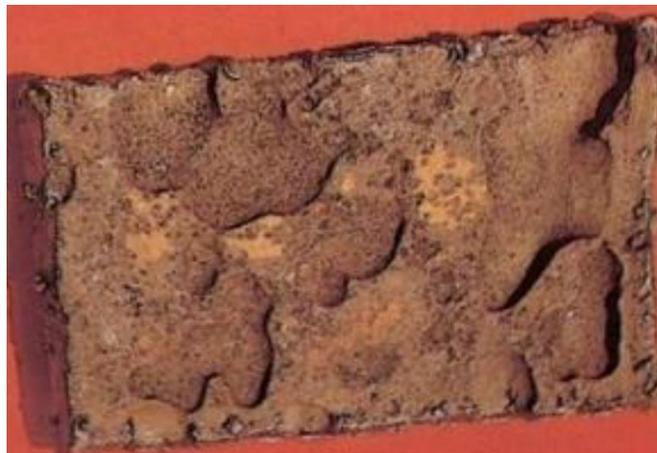
*Figura 4: Corrosão por placas.*
