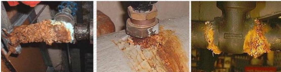
*Figura 7: Exemplo de corrosão galvânica. Fonte: Apotamentos de Soldadura e Protecção de metais. UEM-FE Prof. Dr Engº Justino B. Mulima*
