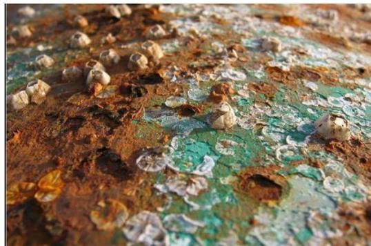
*Figura 9: Corrosão Alveolar. Fonte: Engenheiro de Materiais (2017)*
