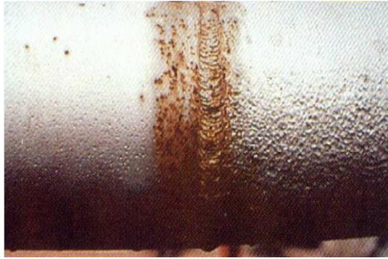
Figura 12: Exemplo de corrosão selectiva Fonte: Apontamentos de Soldadura e Protecção dos metais. UEM-FE Prof. Dr Engº Justino B. Mulima
