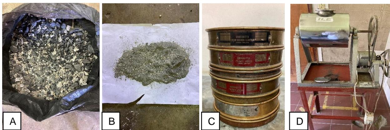
**Figura 14** – A: cinzas descartadas; B: Cinzas usadas; C: peneiras; D: Moinho de bolas.
