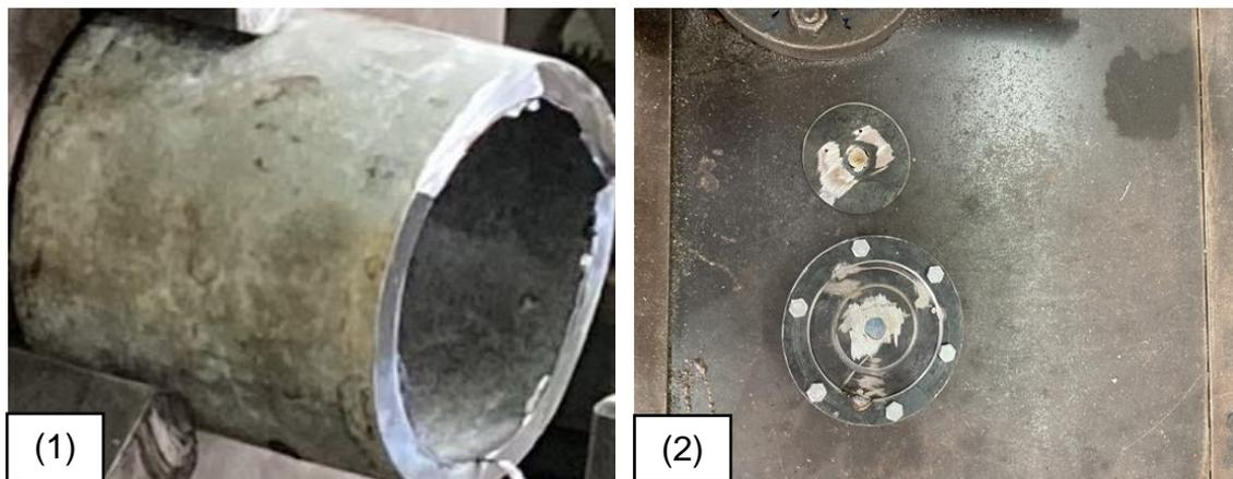
Figura A1-1: (1) Tubo de aço galvanizado e (2) chapa da base e a tampa do reactor.
