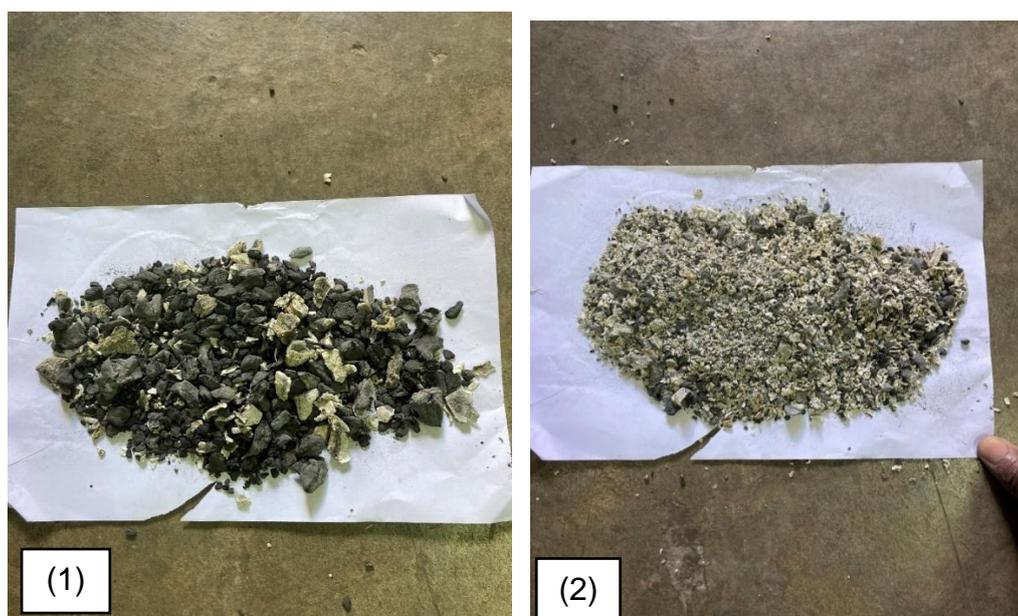
Figura – A2-1: (1) Massa retida na peneira de 11,2mm e (2) Massa retida na peneira de 2,38mm.
