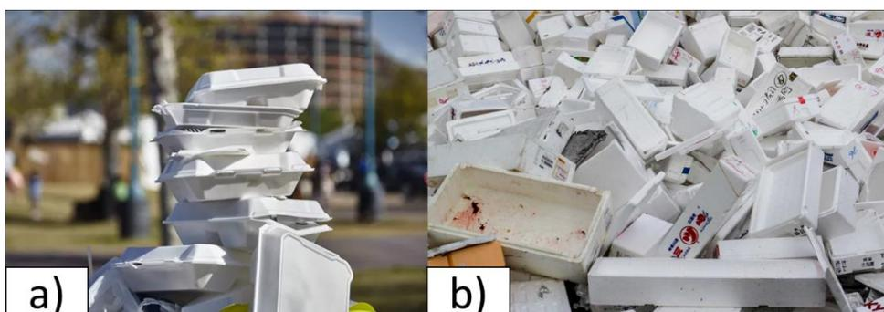
**Figura 4:** (a) Embalagens de EPS do tipo bandeja (b) Poliestireno expandido em outras formas.
