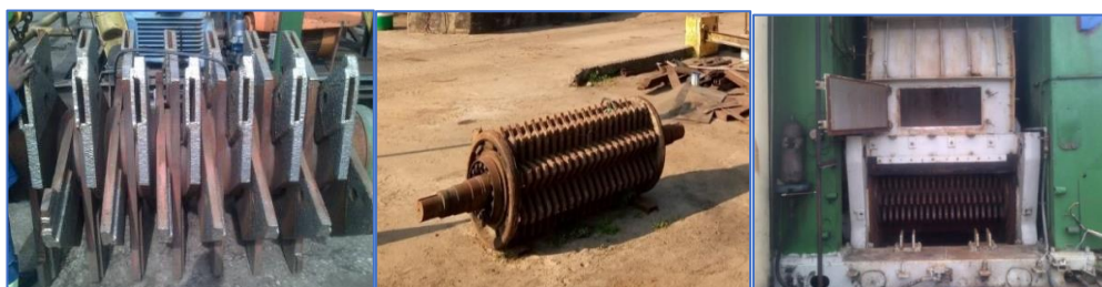
Figura 22. Lotes de facas primárias (1), secundárias (2) e desfibrador modelo Searby (2).
