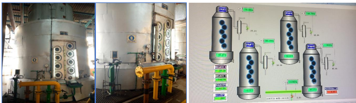
Figura 29. Painelas descontínuas de James Brown & Hammer LTD
