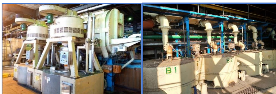
Figura 31. Centrífugas contínuas de massas B e C (Broadbent e Robert) e centrífugas descontinuas Broadbent & Sons LTD.
