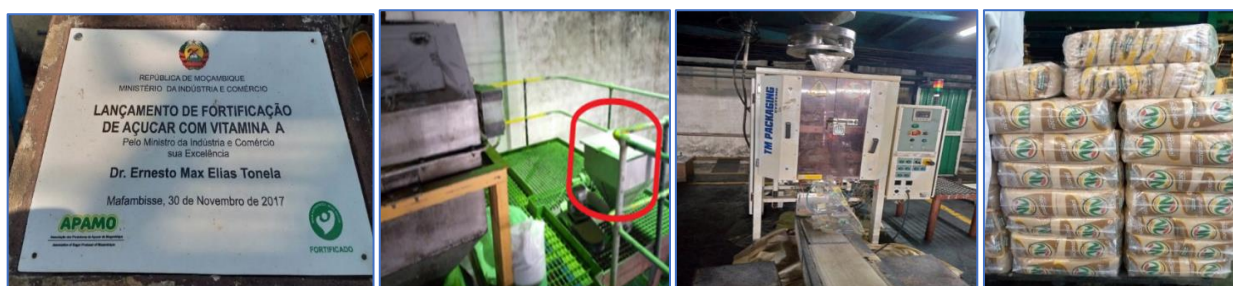
Figura 33. Placa de lançamento de fortificação de açúcar, doseador de vitamina A, máquina de empacotamento e embalagens do açúcar
