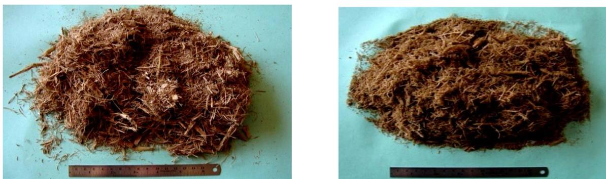
*Figura 21 - amostras do bagaço antes e depois da homogeneização*
