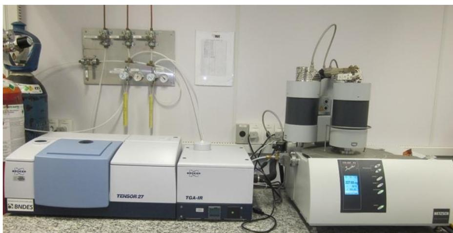
*Figura 22- TGA acoplado ao infravermelho*
