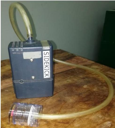
**Figura 17** - Bomba de amostragem
