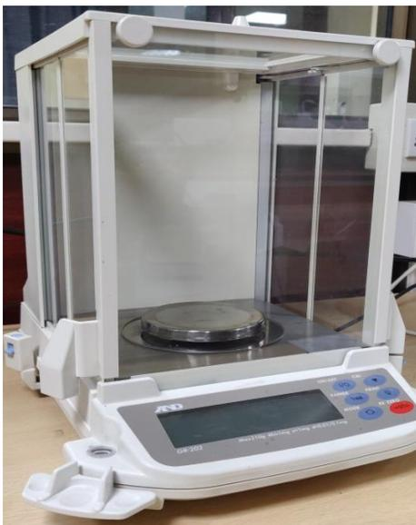
**Figura 18** - Balança Analítica
