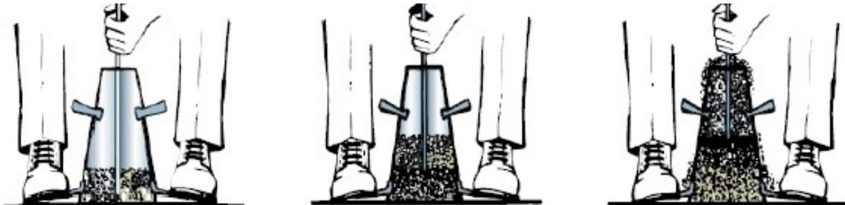
Figura 13 - Ilustração de preenchimento do cone de Abrams
