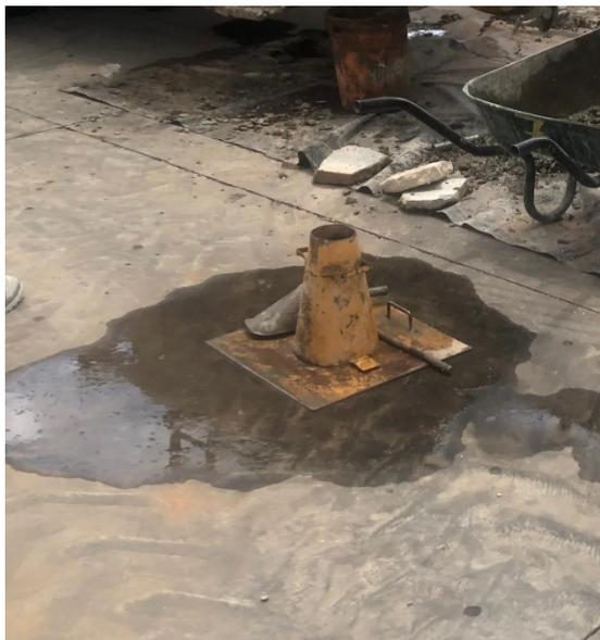
Figura 11 - Materiais para ensaio de abaixamento
