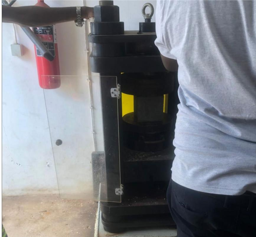
Figura 26 - Equipamento de ensaio de resistência à compressão do betão
