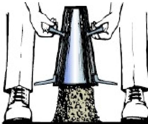
Figura 15 - Ilustração de remoção do cone de Abrams
