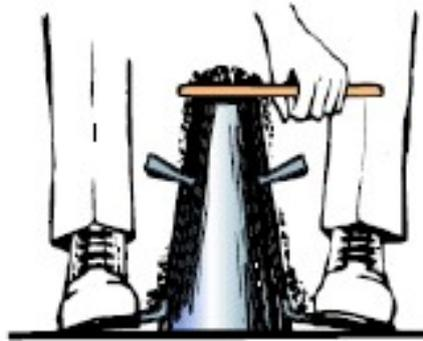
Figura 14 - Ilustração da remoção do excesso no cone de Abrams
