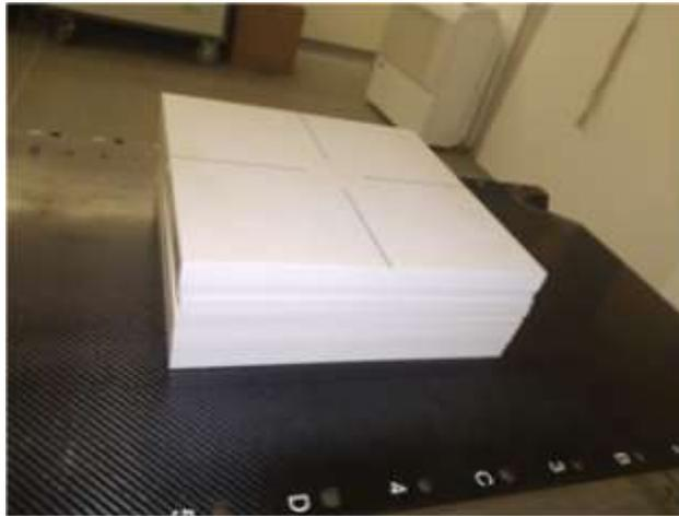
Figura 14: Placas de água sólida (fonte: HCM).
