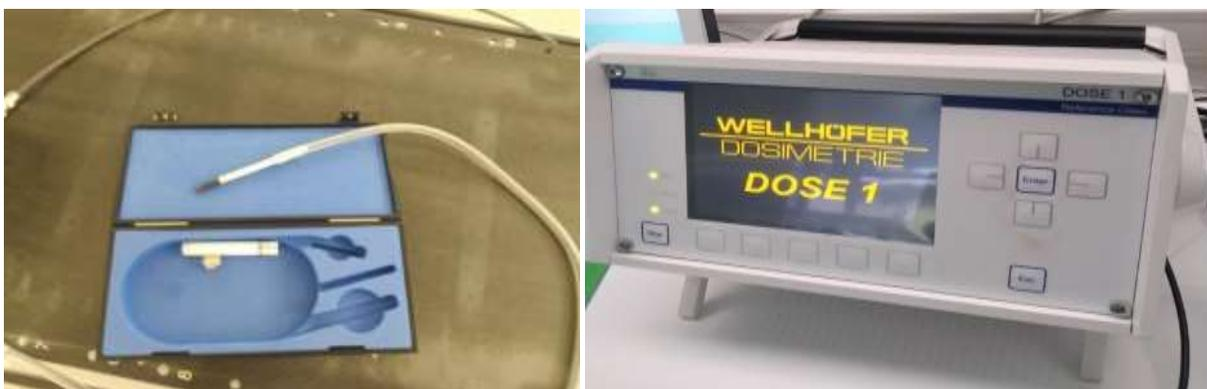
Figura 13: Câmara de ionização do tipo Farmer e o electrómetro Dose 1 (fonte: HCM).
